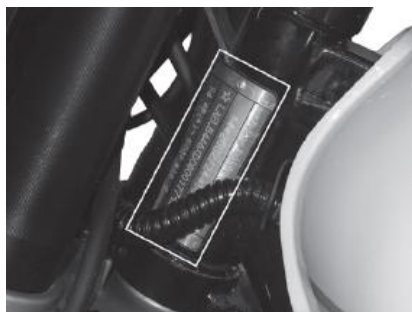
Ubicación de la placa metálica de características
